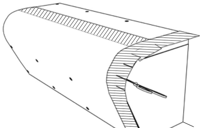
13) Tous les raccords perpendiculaires et faces frontales visibles sont dotés de la bande d'armature JACKOBOARD® autocollante.
