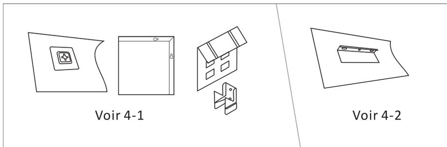
2. Mesurer la distance entre les 2 points de fixation, fixer la cheville dans le mur puis insérer les vis ou les crochets.
