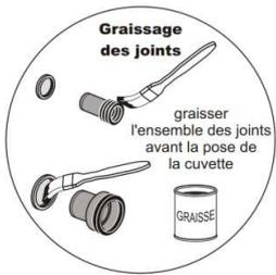
Enduire le tuyau de chasse d'eau et de la pipe d'eau savonneuse ou de graisse silicone pour faciliter leur insertion dans la cuvette.
