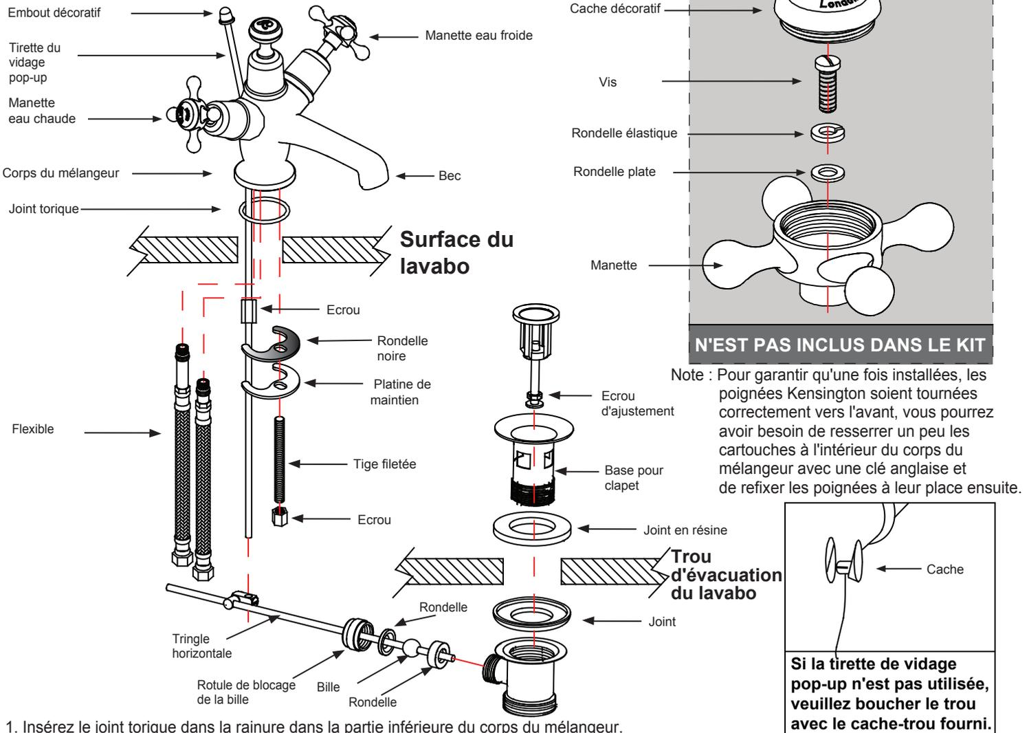
1. Insérez le joint torique dans la rainure dans la partie inférieure du corps du mélangeur.
