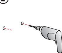
Percez les trous aux endroits marqués en utilisant une perceuse avec une mèche de 6mm
