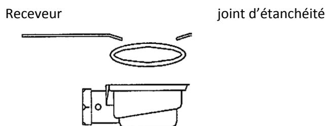
7. Visser la platine au corps de la bonde. Placer le panier Siphon et la grille de vidange.
