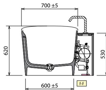
\* Zone pour la prédisposition de la connexion électrique en cas d'éclairage périphérique. Prévoir une télécommande pour la mise en marche et l'arrêt (non fournie).
